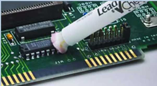
Протрите тестируемую область активизированным наконечником-кисточкой карандаша-тестера LeadCheck®
