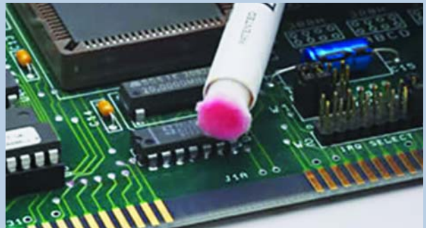
Если наконечник-кисточка LeadCheck® окрасился в розовый или красный цвет, то тестируемая поверхность содержит свинец
